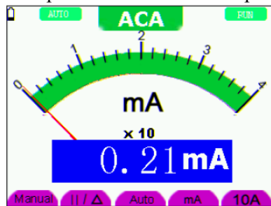
Рис. 29: Измерение переменного тока до 400 mA (ACA)
