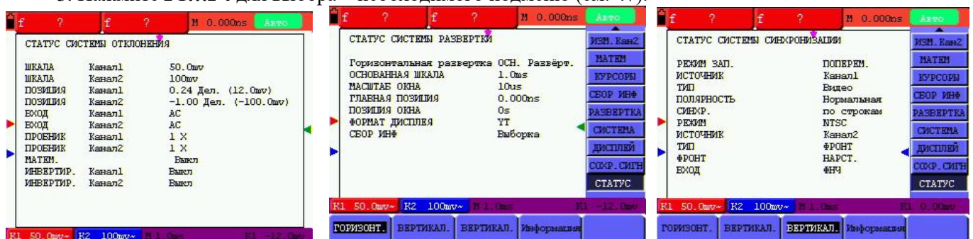
Рис. 47: Системные настройки (Вертик./Горизонт/ / Синхр)
