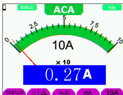
Рис. 30: Измерение тока до 20А (АСА)
