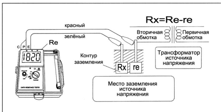
**RX** – действительное значение сопротивления заземления
