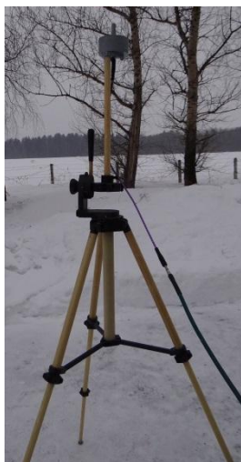
Фото 3. Антенна АС7.23 на диэлектрическом штативе
