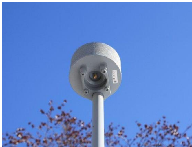
Фото 2. Антенна АС7.23, разъем SMA-типа
