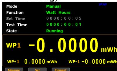
2. Для остановки интегрирования нажать кнопку **Stop** на передней панели.
