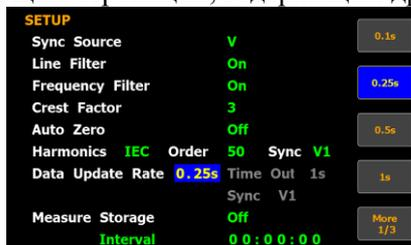
Диапазон **0.1s/0.25s/0.5s/1s/2s/5s/10s/20s** Измеренное значение обновляется на экране в соответствии с заданным временным интервалом. Например, иконка статуса [**Update 5s**] на дисплее загорается зеленым цветом при выборе настройки **5 сек.**
