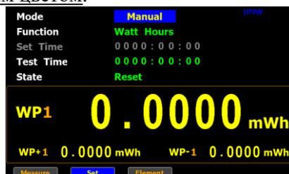
Интегрирование будет выполняться до максимально возможного значения времени ( $\leq 10.000$  часов) или до остановки вручную.
