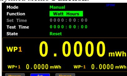
7. Нажать кнопку **Enter**, курсорными кнопками **вверх/вниз** выбрать вид измерения (подсвечен синим фоном): **Ampere Hours**/ Ампер\*Час или **Watt Hours** /Ватт\*Час.
