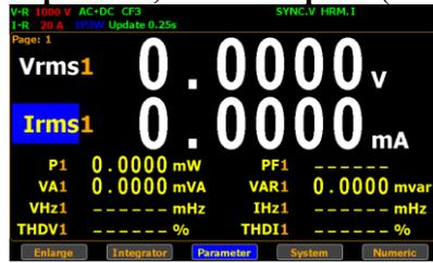
4. После выбора параметра, который необходимо изменить нажать кнопку **Enter**. Подсветка параметра с зеленого цвета изменится на синий. Курсорными кнопками **вверх/вниз** изменить измеряемый параметр. Для подтверждения выбора нажать кнопку **Enter**.
