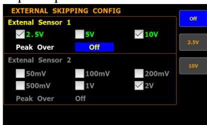
Настройки При появлении пик. значений с превышением предела (over-range) в режиме автовыбора диапазона (Auto range) на внешних входах **Ext-1** и **Ext-2**, пользователь может задать диапазон измерений для переключения на этот номинал. Доступные варианты выбора в каждом из режимов перечислены ниже.
