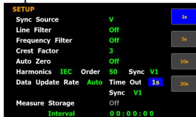
Диапазон **1s/5s/ 10s/20s** Значение интервала **Time Out** определяет ограничение по времени при детектировании периода формы входного сигнала (time limit)
