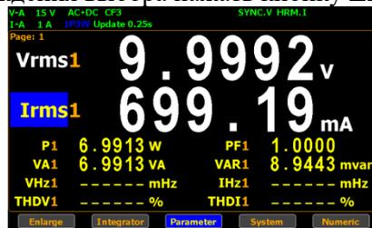
5. Пользователь может применить вышеприведенные операции настройки для каждого из доступных параметров измерений. Предусмотрено до 2-х основных (major) и 8 вспомогательных (minor) параметров измерений, которые будут включены для индикации на экране.
