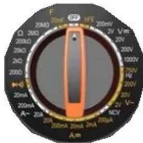
Рис. 6.2. Переключатель режимов (селектор)
