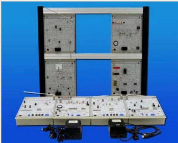
Система передатчика и приемника АМ/ЧМ/АМн/ЧМн KL-900C является многофункциональной автономной системой, предназначенной для проведения экспериментов по передаче АМ/АМн и ЧМ/ЧМн сигналов.
