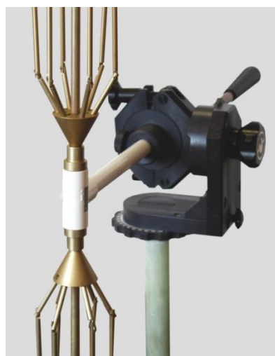
Фотографии 5 и 6. На примере антенны П6-121 с узлом крепления на диэлектрическом штативе (ШАД-01)
