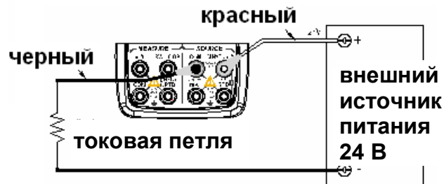
Рисунок 9. Формирование постоянного тока в токовой петле с внешним источником питания
