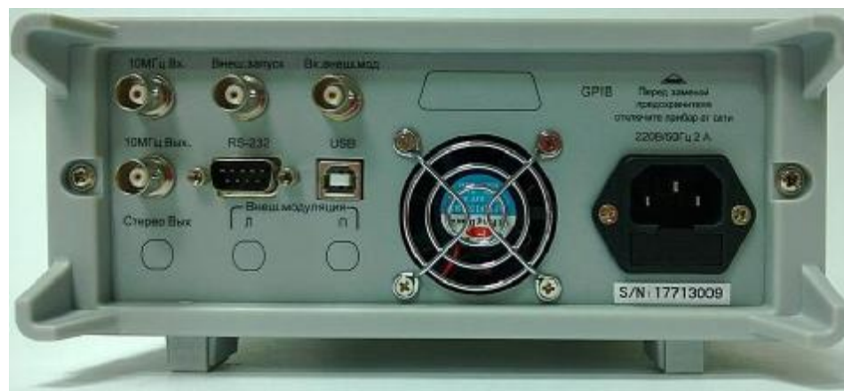
Рисунок 4 – Вид задней панели генератора АК ИП-3410
