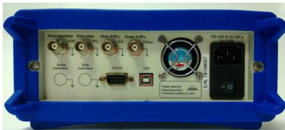
Рисунок 3 – Вид задней панели генератора АК ИП-3407
