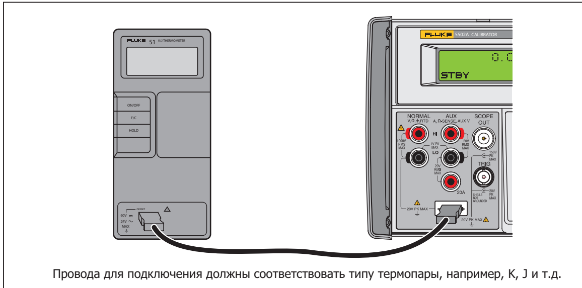
Рисунок 4-10. Подключение испытываемого устройства: Температура (Термопара)
