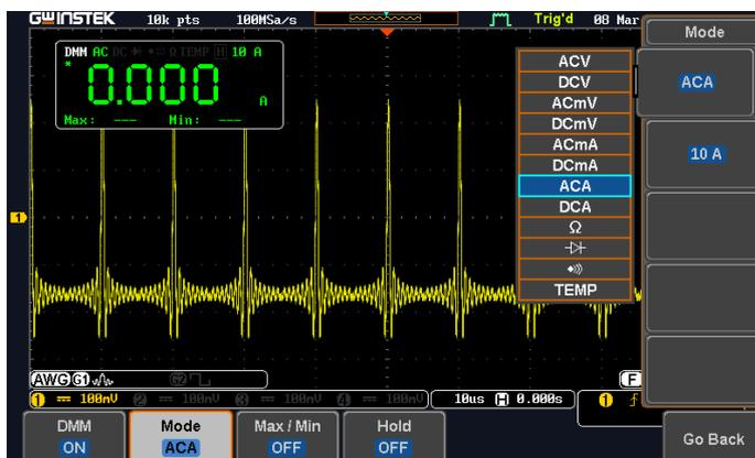
Используйте поворотный переключатель для выбора типа измерения. Для подтверждения выбора нажмите кнопку *Установка*
