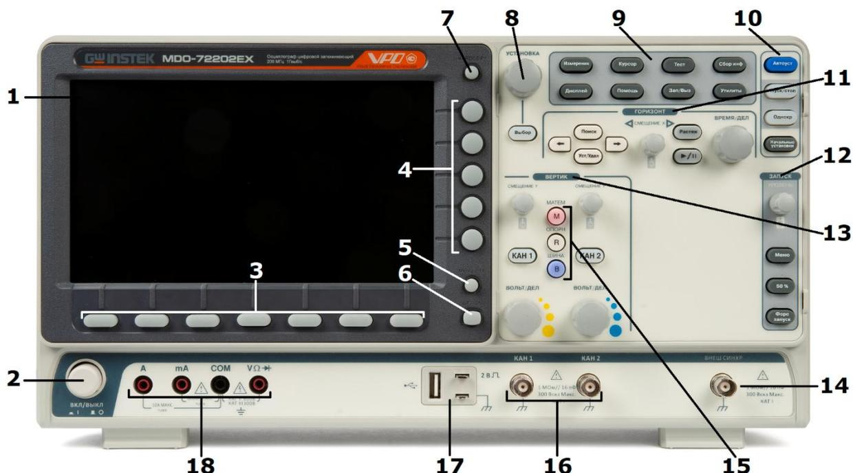
Рис.1 Передняя панель **MDO-72072EX / 72102EX / 72202EX**
