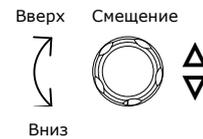
При движении осциллограммы вертикальное положение курсора отображается на дисплее.
