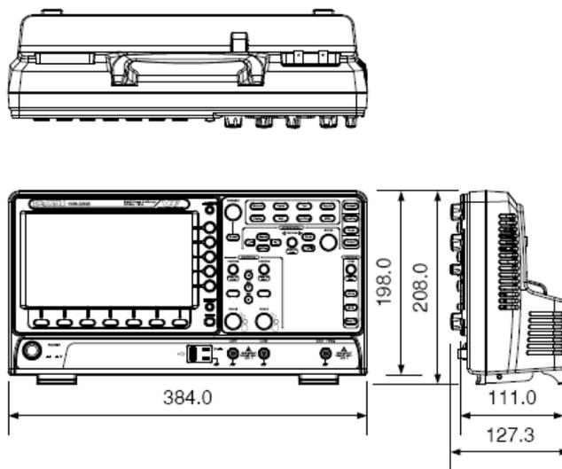
Рис. **MDO-72000EG/EX** в ортогональной проекции
