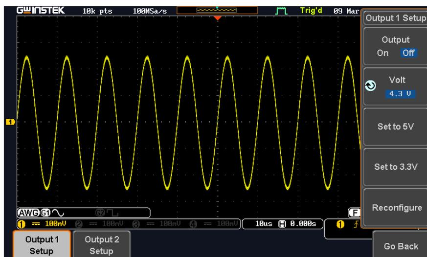
Эта кнопка включает / выключает выход канала
