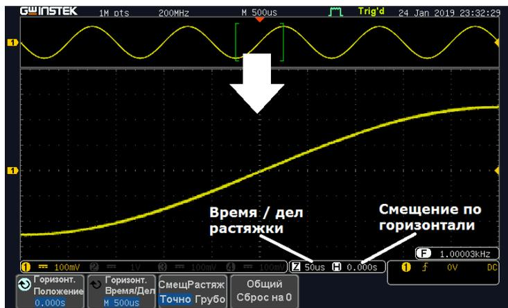
**Перемещение по горизонтали** Для прокрутки осциллограммы влево или вправо следует использовать регулятор *Установка*.
