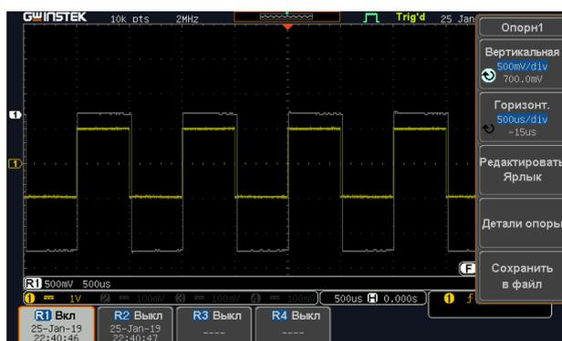
Для редактирования вертикального смещения или параметра Напряжение/Дел следует повторно нажать в боковом меню кнопку *Вертикальная*
