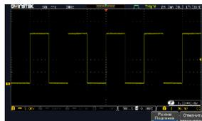
3. Для отмены автоматических настроек следует нажать в нижнем меню кнопку *Отменить Автоуст* в нижнем меню. Для того чтобы скрыть кнопку *Отменить Автоуст*, достаточно нажать любую другую кнопку.
