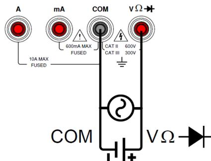
Для предотвращения выгорания внутренних цепей мультиметр будет препятствовать переключению диапазонов напряжения во время измерения, когда вход больше 10V. Для переключения диапазонов сначала отключите пробник от тестируемого объекта.
