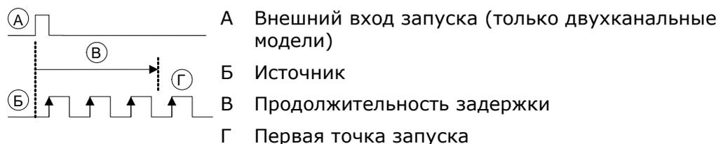
**Длительность импульса** Сигналы запуска при длительности импульса в сигнале меньшей, равной, неравной или превосходящей заданную длительность импульса.
