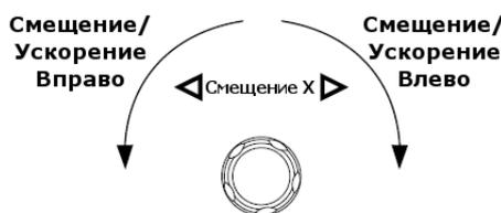
**Сброс смещения** Для сброса горизонтального смещения и смещения растяжки нажмите кнопку *Общий сброс на 0*.
