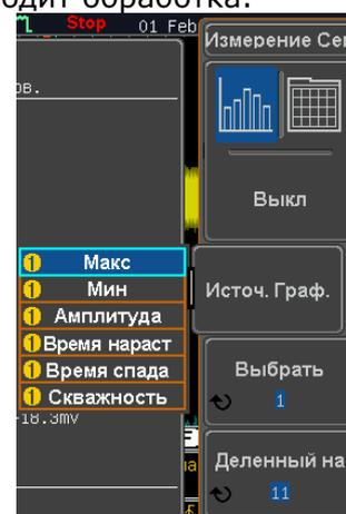
6. Для формирования таблицы измерений нажмите кнопку *Источник* и выберите канал для которого производятся автоматические измерения.
