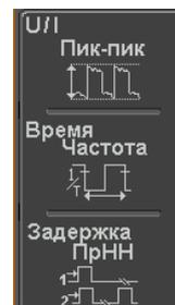
Все индивидуальные измерения будут выведены на дисплей в окне в нижней части экрана. Номер и цвет канала показывают источник измерения: жёлтый = Кан1, голубой = Кан2, розовый = Кан3, зелёный = Кан4.
