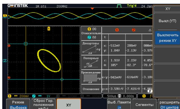
Для изменения положения XY осциллограмм следует использовать регулятор Смещение Y: регулятор Канала 1 выполняет перемещение XY осциллограмм в горизонтальном направлении, а регулятор Канала 2 перемещает Y осциллограммы в вертикальном направлении.
