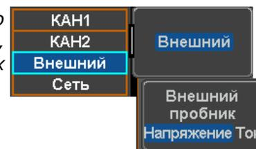
6. Для выбора типа связи для сигнала запуска или настроек фильтра частоты следует нажать кнопку *Связь* в нижнем меню.
