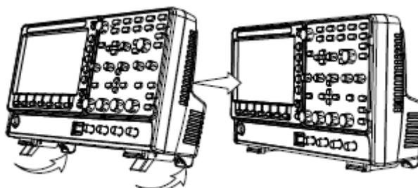
**Наклонное расположение** Для наклонного расположения прибора, отведите упоры на задней панели в направлении от задней панели позади корпуса, как показано ниже (по стрелкам) на левом рисунке.
