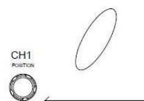
Регуляторы Смещение X и регулятор Время/дел могут быть также использованы в режиме XY.
