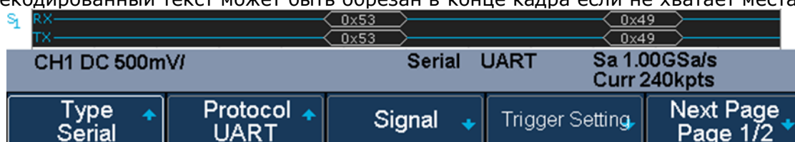
Рис. 12-14 Пример результата декодирования сигнала UART/RS232
