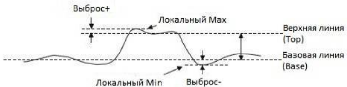
Рис. 16-2 Выбросы на импульсном сигнале
