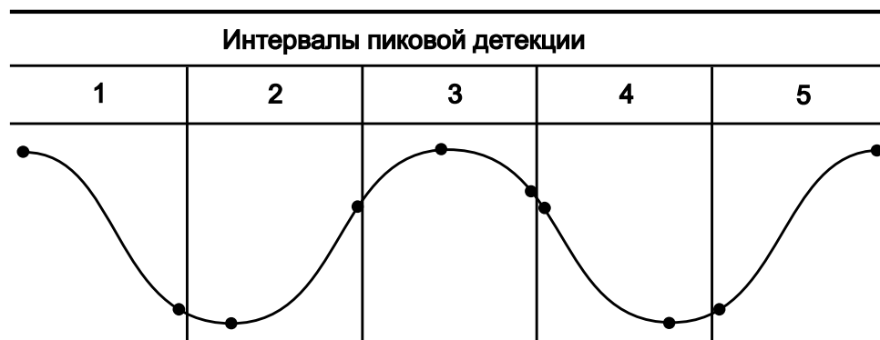
Рис. 10-5 Принцип формирования выборок пикового детектора
