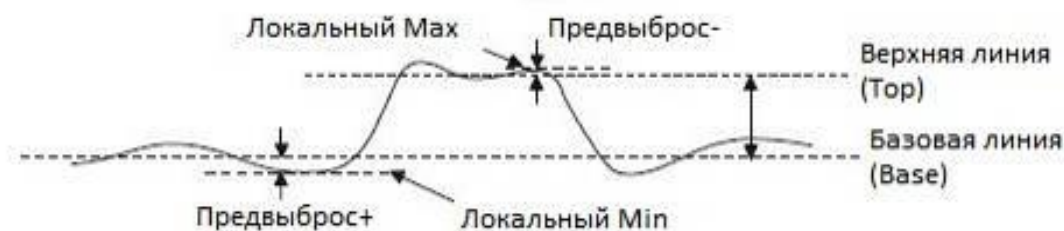
Рис. 16-3 Предвыбросы на импульсном сигнале
