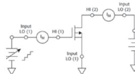
Измерение субпорогового напряжения полевого МОП транзистора с помощью пикоамперметра и источника напряжения (модель 6482).
