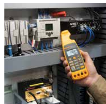
Измерение сигналов 4-20 мА без необходимости разрыва цепи
